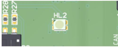
Яркостью свечения каждого светодиода HL2 возможно управлять с помощью ШИМ, генерируемым TMR2 для зелёного и TMR3 для красного и синего.
