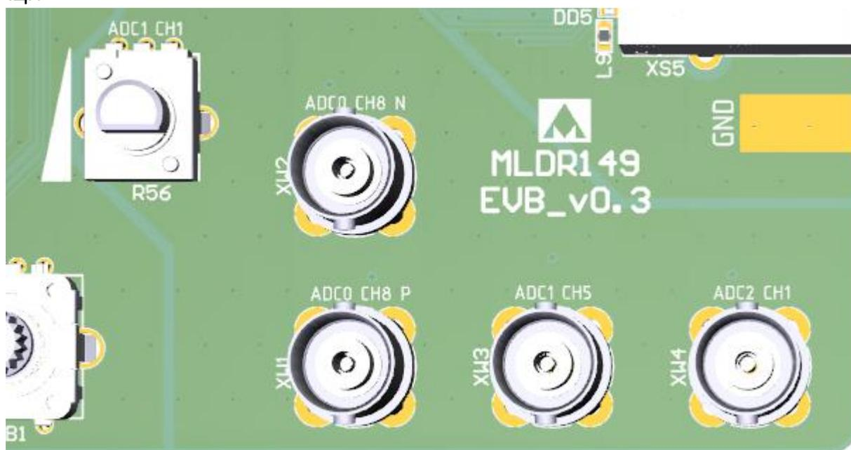
На BNC разъемы XW1, XW2, XW3, XW4 выведен 8-ый канал ADC0, 5-ый канал ADC1, 2-ый канал ADC2. К ADC0 возможно подключение как обычного, так и дифференциального сигнала (сигнал должен быть симметричен относительно половины опорного напряжения АЦП).
